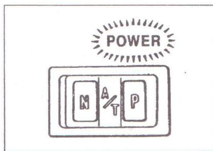
Тази трансмисия има и селектор за избор на стила на управление. Когато се нуждаете от по-голяма теглителна сила при изкачване на наклони или при бързо ускоряване на автомобила, включете превключвателя в позиция "P" (мощност). При това положение на арматурното табло светва индикаторната светлина "POWER". За нормално управление на автомобила, включете превключвателя в позиция "N" (нормално). Сега вече индикаторната светлина "POWER" изгасва.
