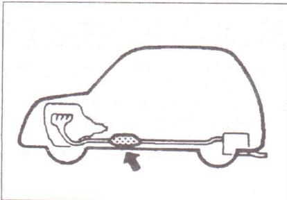
Катализаторът служи да преобразува вредните компоненти в отработилите газове на Вашия автомобил. Използването на оловен бензин, при автомобилите с катализатор е забранено от федералните закони, защото оловото ще дезактивира катализатора.
