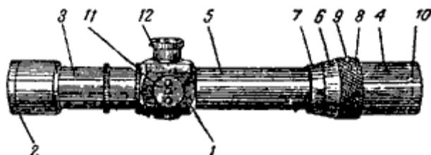
**Схема 6.** Общий вид оптического винтовочного прицела ПЕ:
