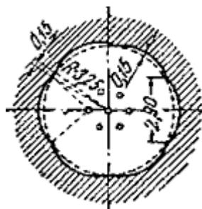
*Схема 138.* Нарезы 6,5-мм винтовки системы Арисака
