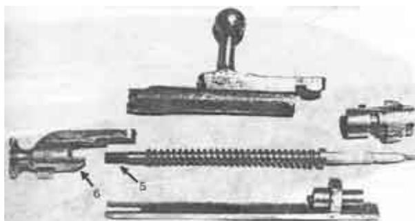
**Фото 20.** Разобранный затвор. Внимание: для обеспечения сборки затвора
