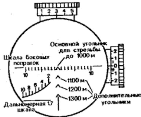
**Схема 20.** Сетка прицела ПСО-1, установленного на снайперской винтовке СВД
