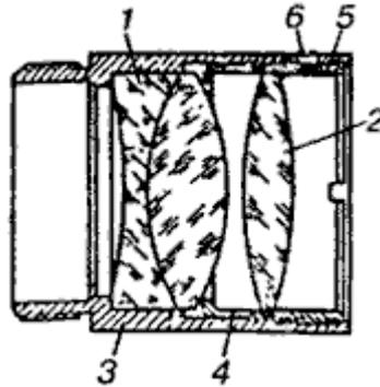
**Схема 15.** Разрез окуляра прицела ПУ:
