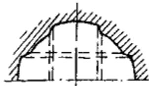
**Схема 136.** Нарезы трапециевидальной формы
