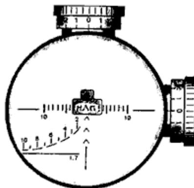
**Схема 27.** Прицеливание прицелом ПСО-1. Пуля "падает" на вершину основного угольника - в точку прицеливания. Поле прицела чистое, строго очерченное по краям
