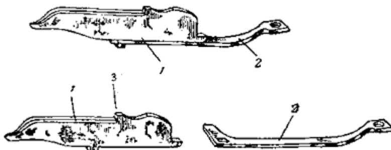
*Схема 4.* Отсечка-отражатель: 1- лопасть; 2 - пружинная часть; 3 - зуб
