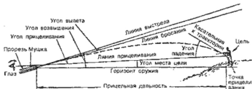
Схема 71. Элементы наводки и траектории стрелкового оружия
