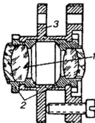
Схема 14. Разрез оборачивающей системы:
