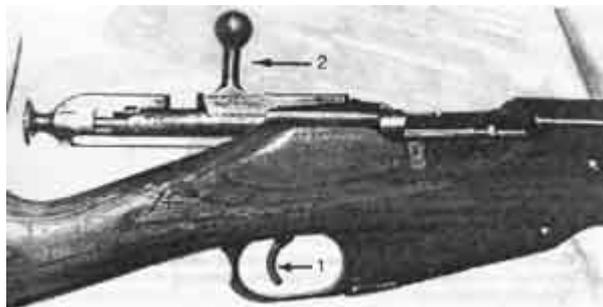
**Фото 16.** Неполная разборка. Извлечение затвора. При нажатом спуске 1 открытый затвор извлечь по направлению стрелки 2. В ствольной коробке видна лопасть-пластина отсечки-отражателя
