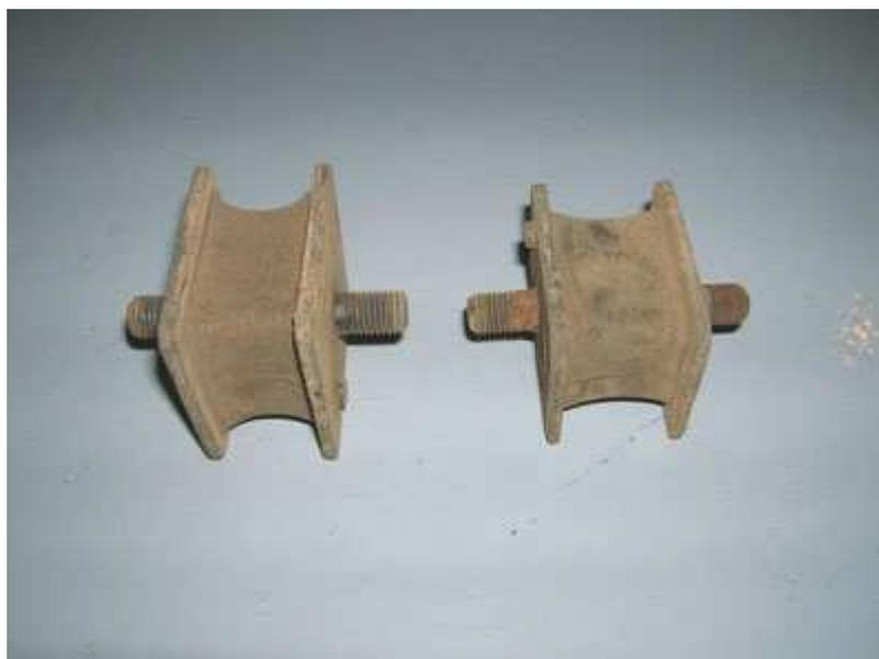
En la imagen, dos tipos de Silent Block usados en un Samurai
