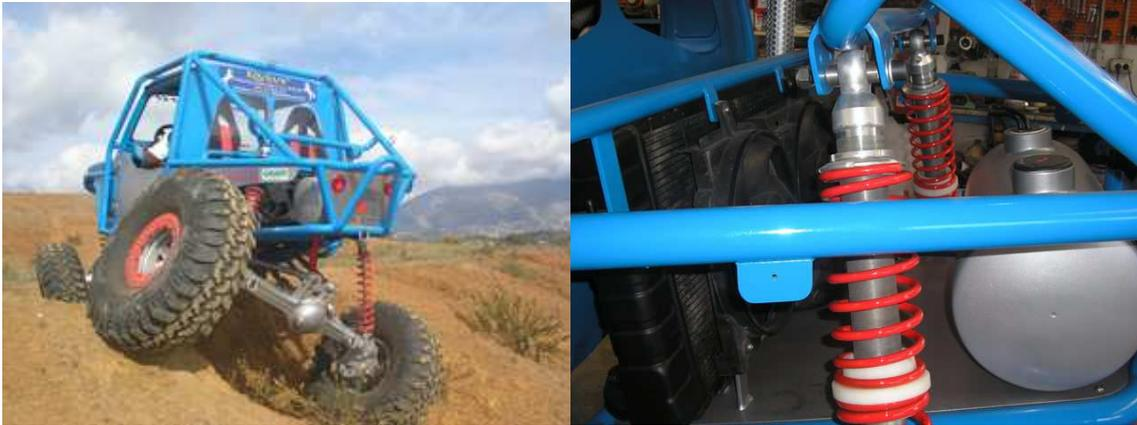
El chasis delantero ha sufrido recorte justo donde va anclada la caja de dirección original. En ese punto se ha soldado un perfil de sección redonda que ha permitido ensanchar el chasis un par de centímetros y así se consigue el espacio necesario para desarrollar el colector. Justo en los extremos delanteros se ha colocado los soportes de las espirales y amortiguadores.
