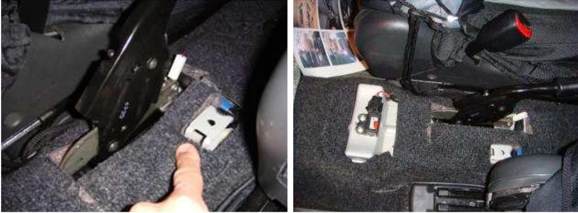
Cortamos con un cutter, un poco de moqueta para trabajar a gusto y tener sitio para la palanca. Una vez hecho esto, se hace una plantilla de cartón con la forma del guarnecido de plástico donde irá luego la palanca atornillada. Hay que hacer 3 agujeros: 1 el del hueco para el cable y la carraca. 2 y 3 para los tornillos de fijación.
