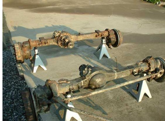
Como el sistema de frenos original que traen estos ejes, es por zapata y tambor, se ha decidido re-equiparlos con frenos de disco en ambos ejes. Los discos son ventilados y las pinzas de freno son de la marca Wilwood.
