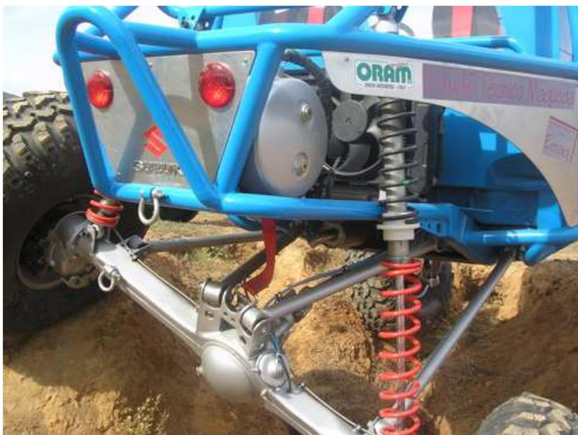
Perfecta visión del sistema 4 link y suspensión del tipo Coilover. El depósito de gasolina se encuentra en el extremo de la carrocería, para compensar el peso del vehículo. También podemos ver el radiador y el sistema de ventilación.
