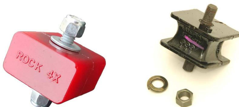
**Silent block semi-rígido:** Es aquel que dispone de elementos de goma como elemento de absorción de vibraciones, pero que es atravesado completamente por un tornillo que realiza el anclaje entre la transfer y chasis. De esta forma tan sencilla se impide que el silent block se parta por la mitad, cuando se le someta a una fuerza extrema. Solo recomendado para ser usado en combinación con otros refuerzos de transfer.
