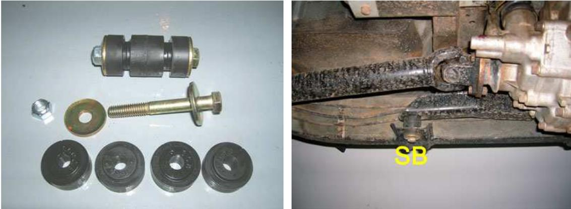
A la izquierda tenemos un ejemplo de Silent Block semi-rígido armado y desarmado. La fotografía de la derecha tenemos el mismo SB, combinado con un brazo reforzado del fabricante Spidertrax.
