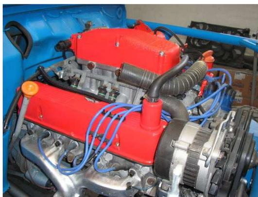
Al adaptar el motor con su caja de cambios en el chasis, se ha tratado de dejarlos engrasados con la parte baja de las vigas del chasis, para poder proteger los bajos con una chapa de aluminio, y no tener ningún tipo de obstáculos.
